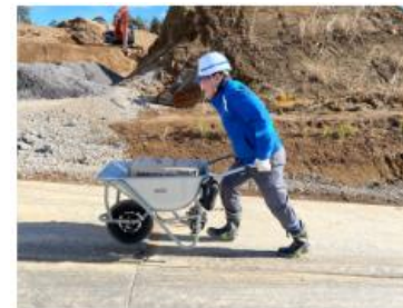
電源を入れない状態での運搬 (通常の一輪車として使用した状態)
