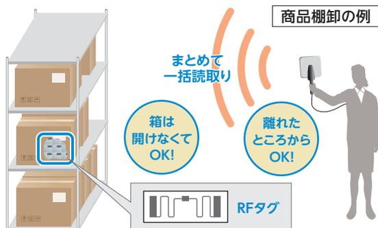
現在、在庫管理や入庫・検品などで使用されているバーコードは、製品のバーコード部分に光を当て1つ1つ読取る必要があります。一方、UHF帯RFIDは電波を用いるため、交信可能な範囲であれば、離れたところからでも複数のRFタグのデータを、一括で読取ることができます。UHF帯RFIDを導入することによって、大幅に**作業時間が短縮**され、例えば、今まで多くの人員の投入が必要だった棚卸作業なども短時間かつ少人数で完了させることができ、**業務の省力化**が期待されています。
