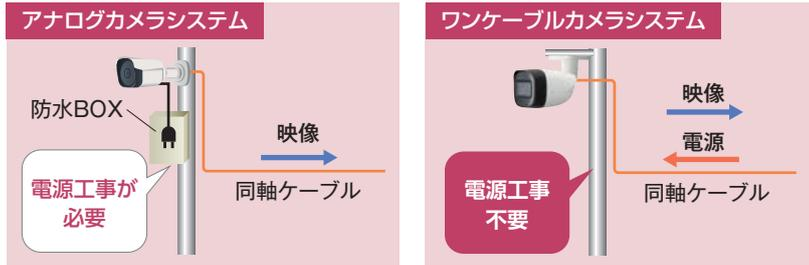
フルハイビジョンなどの高画質で撮影した映像を、既存のアナログカメラの同軸ケーブル配線をそのまま利用して伝送、録画ができるのが、『同軸カメラシステム』ですが、さらにその同軸ケーブルでカメラへの電源供給もできるのが、『ワンケーブルカメラシステム』です。1本の同軸ケーブルで映像伝送と電源供給ができるので、カメラの設置場所での電源配線工事が不要ありません。
