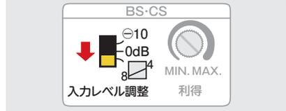
アンテナからブースターまでのケーブルが長くなり、高い周波数の電波が弱くなったとき、入力レベル調整スイッチを8dBにすると電波の波形がフラット近くなります。
