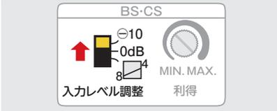
分配数が少ない、伝送距離が短いなど、信号の減衰が小さい場合、入力レベル調整スイッチを⊖10にして運用します。
