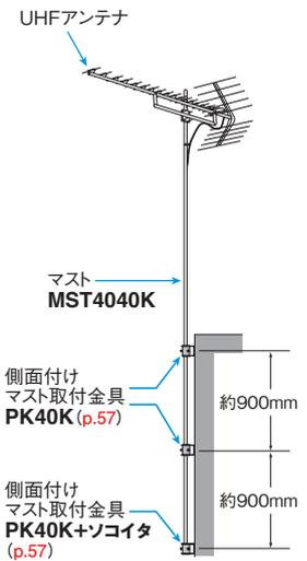
取付るアンテナの種類や設置環境などにより、マスト取付金具の数量や間隔は変わります。
