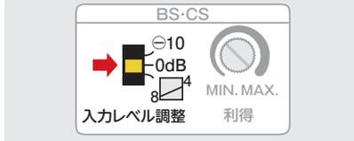
分配数が多い、伝送距離が長いなど、信号の減衰が大きい場合、入力レベル調整スイッチを0dBにして運用します。
