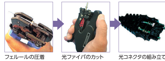
圧着カット式コネクタの組み立て（光コネクタCF-2071の場合）
