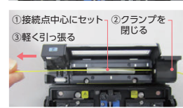
①接続点中心にセット ②クランプを軽く引っ張る ③クランプを閉じる
