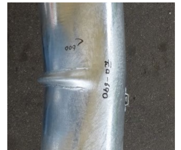
破壊時の局部座屈
